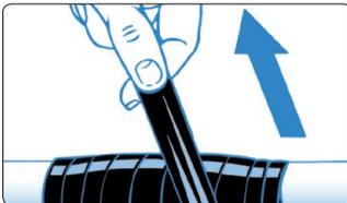
2. ... das Band auf seine doppelte Länge dehnen, fest um die Oberfläche wickeln ...
